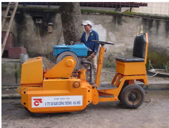
Figure 70: Mini vibrating roller CR 10A (1000 kg)
