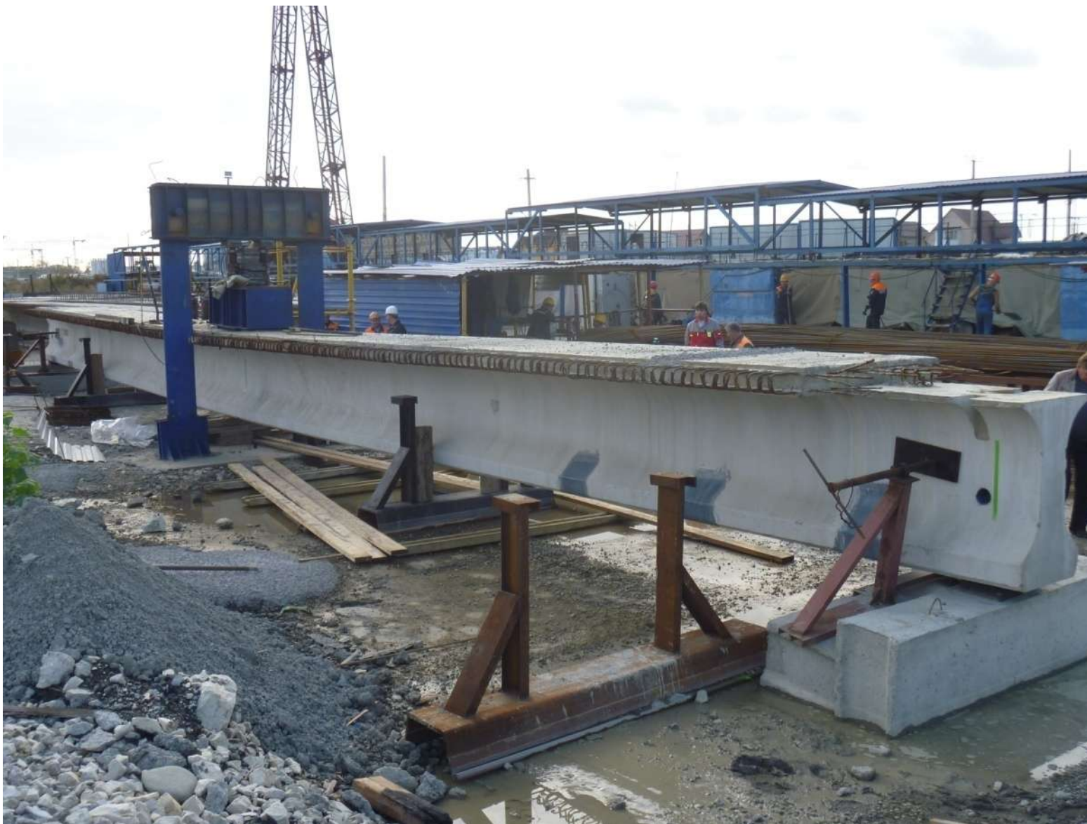
Общий вид испытательного стенда с установленной усиленной балкой длиной 24 м под воздействием испытательной нагрузки
