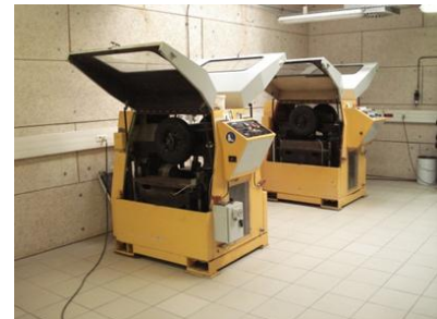
The rutting test – EN 12697-22
